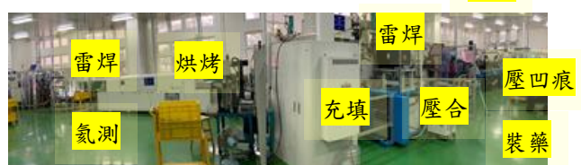
圖 7 合併後單體生產線
