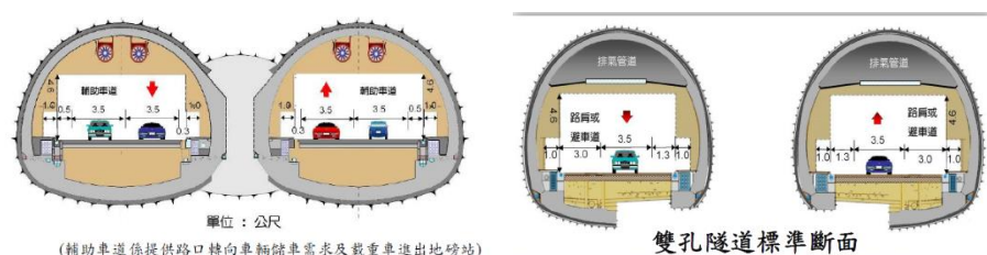
圖1 蘇花改蘇澳、東岳短隧道以及東澳、觀音、谷風、以及中仁長隧道標準橫斷面
