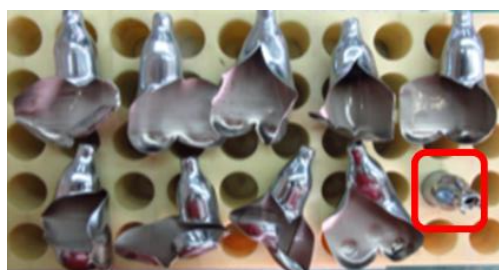
圖 3 原產品烘烤爆破後實照
