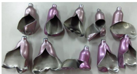
圖 1 C 產品烘烤爆破後實照
